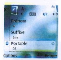
La configuration pour l'envoi des SMS s'effectue de manière identique mais dans le champ **Suffixe**, il faut indiquer *Sms*. Il est possible d'ajouter plusieurs contacts (jusqu' à 10) avec le même suffixe *Sms* (il n'y a pas de cascade de SMS, mais un envoi multiple).
