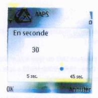
Si le téléphone reste plus longtemps à un angle supérieur à 45° que le temps défini dans « *Tempo Verticalité* » (de 5 à 45 secondes) un message « *Alarme CHUTE* » apparaît à l'écran. Ce message s'accompagne d'une alarme sonore.
